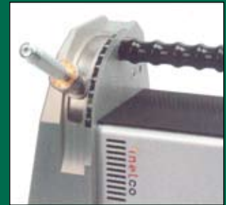
Schleifwinkel-Einstellung von 7,5-90 Grad ergibt einen Spitzwinkel zwischen 15 und 180 Grad.
