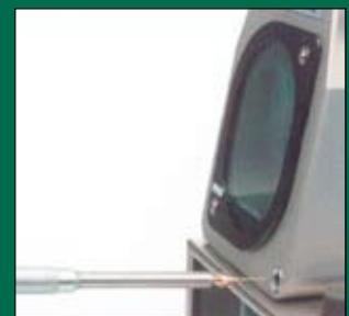
Genauere Einstellung des "Stick-out's der Wolframelektrode.
