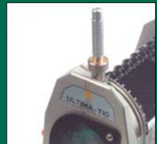
Abflachen der Wolframelektrode in der 90 Gradposition. 1 Punkt an der Noniusschraube gleich 0,1 mm Flächendurchmesser.
